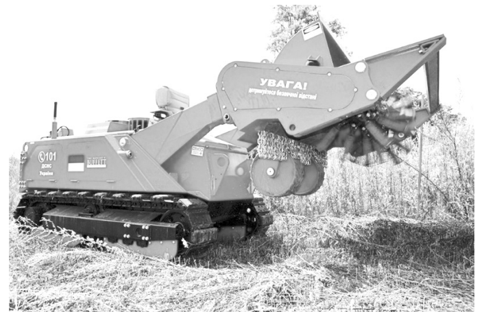
«Жнивує» і машина механізованого дистанційного розмінування. Фото з сайту zemlyaiivolya.net.
